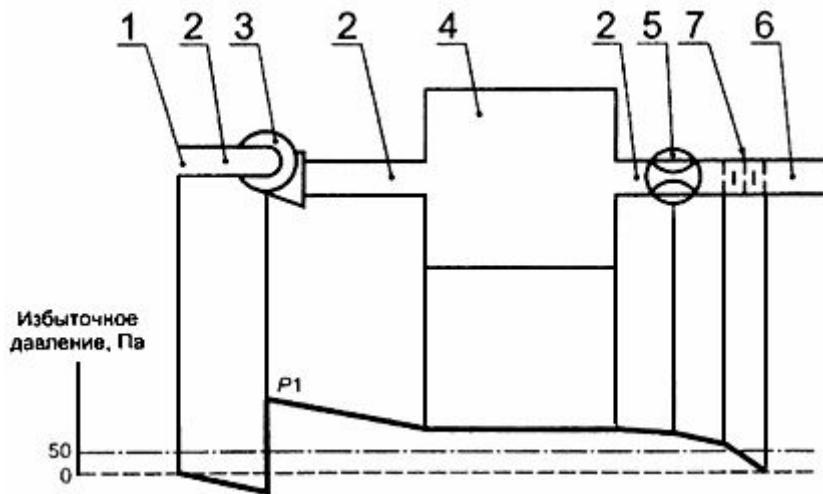
1 - вход защитного газа; 2 - газопровод; 3 - вентилятор; 4 - оболочка; 5 - дроссельная заслонка; 6 - выход защитного газа; 7- барьер защиты от искр и частиц;
