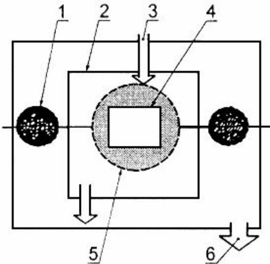
1 - потенциальный источник утечки с номинальной зоной разбавления; 2 - внутренняя перегородка; 3 - вход продувочного газа; 4 - неповреждаемые части встроенной системы;
