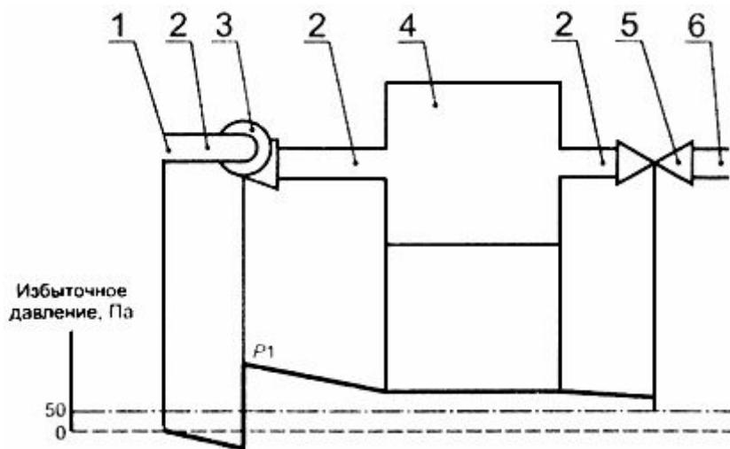
1 - вход защитного газа; 2 - газопровод; 3 - вентилятор; 4 - оболочка; 5 - выходной клапан; 6 - выход защитного газа; P1 - давление защитного газа (практически постоянное)
