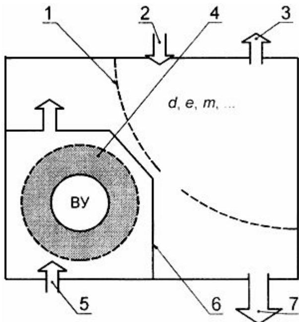
1 - номинальная граница зоны разбавления; 2 - вход воспламеняющегося вещества; 3 - выход воспламеняющегося вещества; 4 - испытание зоны разбавления, 5 - вход продувочного газа; 6 - перегородка оболочки воспламеняющего устройства; 7 - выход продувочного газа
