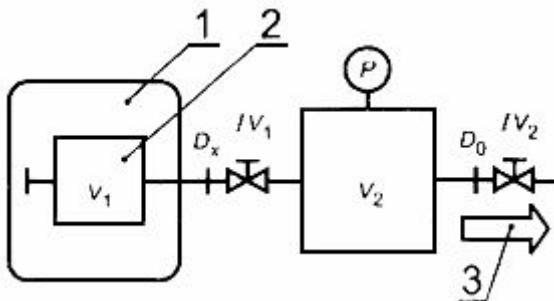
1 - система, заполненная гелием; 2 - испытуемая система; 3 – выход
