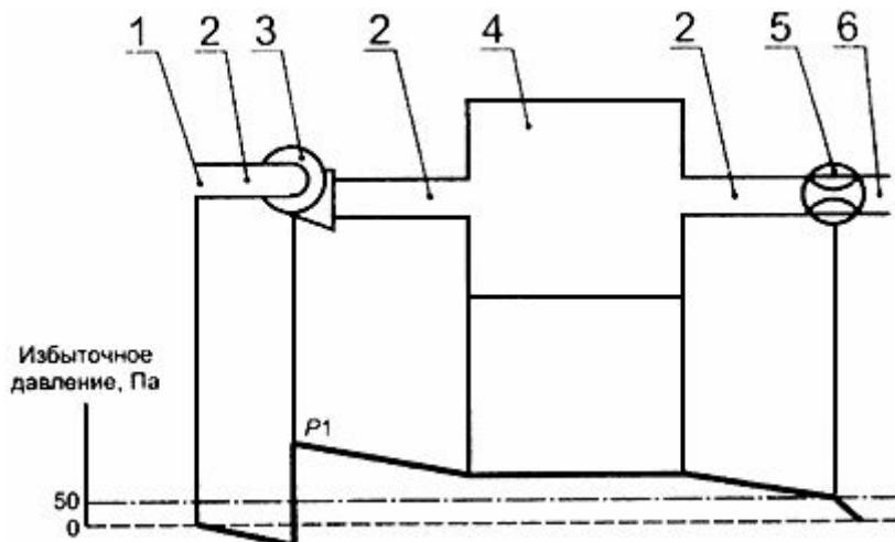
1 - вход защитного газа; 2 - газопровод; 3 - вентилятор; 4 - оболочка; 5 - дроссельная заслонка; 6 - выход защитного газа; Р1- давление защитного газа.
