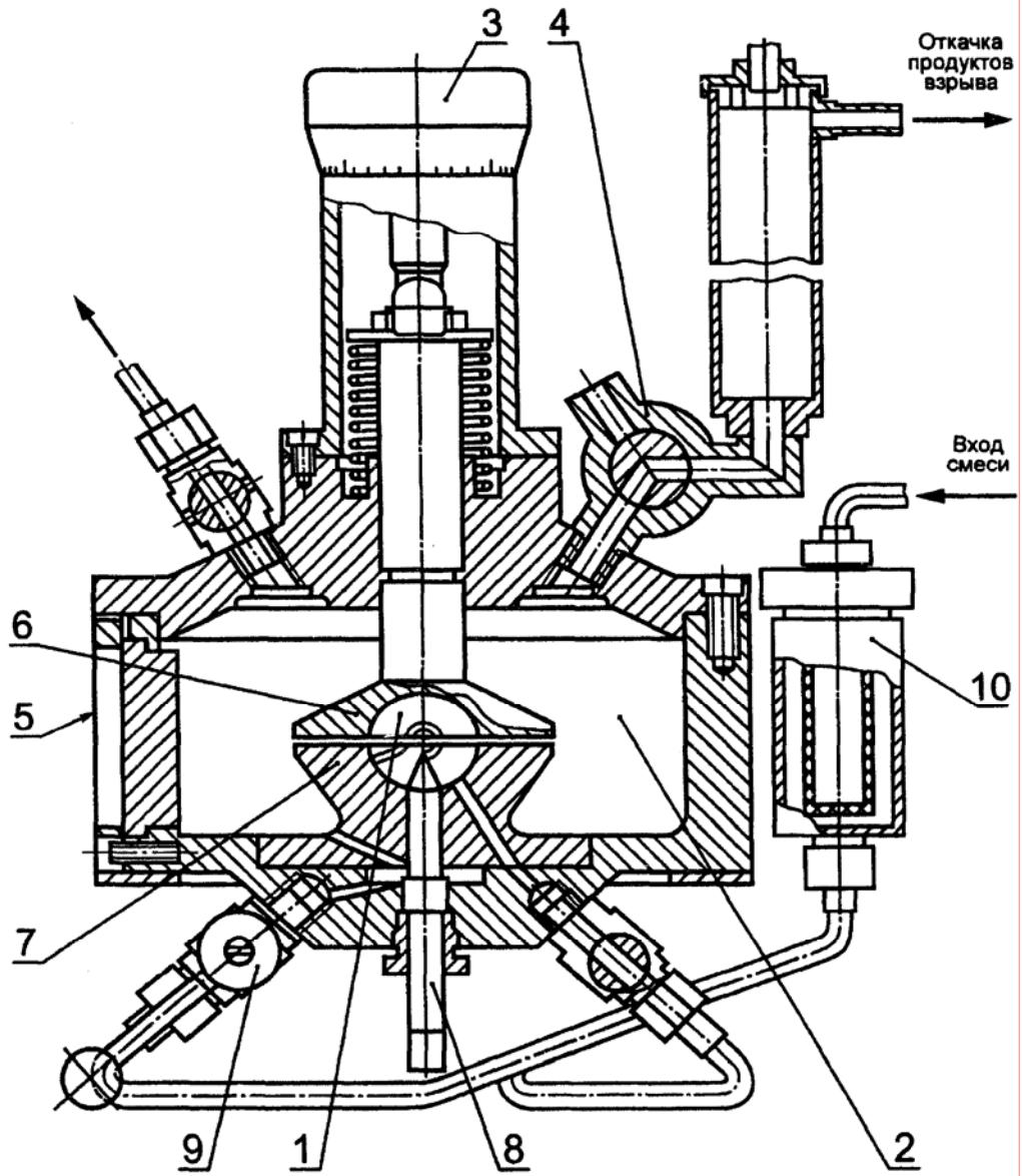
1 — внутренняя камера; 2 — внешняя камера; 3 — микрометрический винт; 4 — насос;
