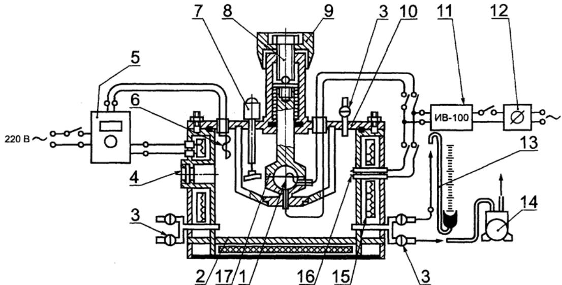
1 — электроды; 2 — камера; 3 — краны вакуумные; 4 — смотровое окно; 5 — блок автоматического терморегулирования; 6 — датчик температуры; 7 — устройство для перемешивания смеси; 8 — микрометрический винт; 9 — головка винта; 10 — крышка; 11 — индуктор высоковольтный; 12 — лабораторный автотрансформатор; 13 — вакуумметр; 14 — вакуумнасос; 15 — нагревательные элементы; 16 — запальная свеча; 17 — сферическая оболочка
