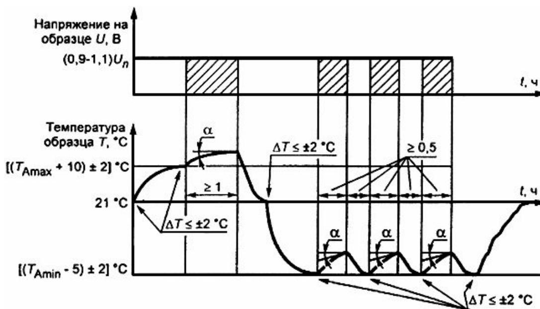
$T_{Amax}$  - заданная максимальная температура окружающей среды в эксплуатации;
