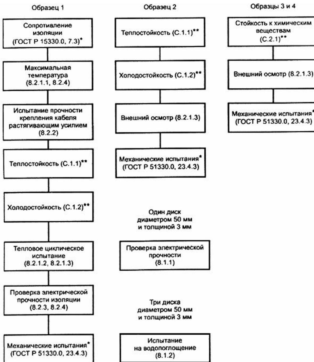
\* За исключением приборов и элементов, достаточно хорошо защищенных от воздействия окружающей среды. В случае, если данное испытание не проводилось, прибор должен иметь маркировку Х, а в сопроводительной документации должны быть указаны ограничения по использованию.
